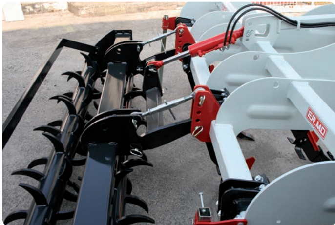
Particolare del doppio rullo posteriore con regolazione idraulica della profondità.
